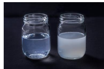
Figura 8 – Transparência de formulação de shampoo com 2% de OXISENSE® S 0440 (à esquerda) em comparação com formulação contendo 2% de silicone (à direita).
